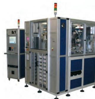
Permette il carico, collaudo, scarico ed etichettatura in modo totalmente automatico tramite vassoi di posizionamento. Completa autonomia superiore alle 4 ore di lavoro.
