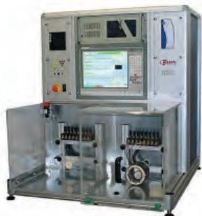
Versione standard per statori fino a 8 terminazioni, 4 prove. Tensione Max 3 Kv. Le opzioni previste permettono di personalizzare il collaudo.
