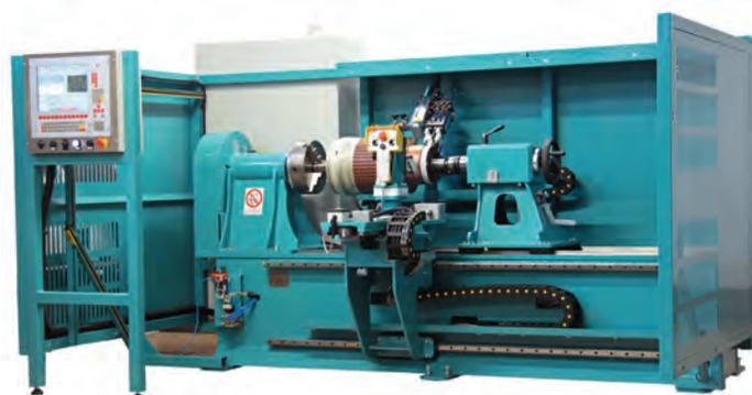
Collaudo automatico per grandi rotori avvolti tipo trazione. Prove: resistenza ohmmica, isolamento, rigidità, IP, SURGE. Ciclo completamente automatico. Particolare attenzione alla sicurezza anti-infortunistica.
