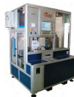
Esempio tipico di collaudo solo meccanico: controllo diametri della sede boccole, piantaggio con controllo curva sforzo su bielle per motori auto (MASERATI). Carico, movimentazione e scarico robotizzati.
