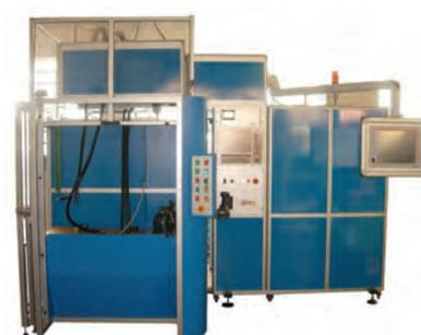
Collaudo completo elettrico ed idraulico di compressori semi-ermetici fino a 80 KW. Prove di sicurezza, assorbimento, funzionamento con rilievo di tutti i parametri. Connessioni rapide automatiche.
