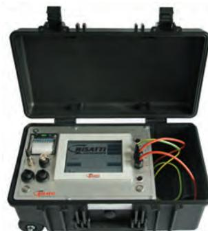
SURGE e rigidità, in D.C. a 6 KV, scariche parziali, isolamento, IP. Alimentazione a batteria da 4 ore. Caratteristiche tecniche come H3/6 CPS, opzione stampante incorporata.
