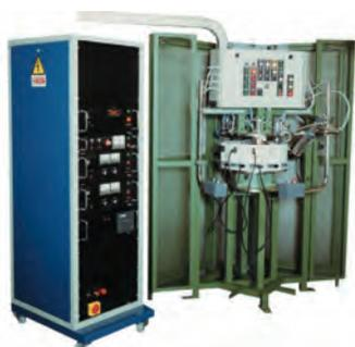
Collaudo di cordoni di alimentazione su tavola rotante. Prove di continuità, isolamento, polarità, rigidità, skin-test, timbratura a caldo. Scarico automatico. Blocchetti prese/spina intercambiabili. Tempo ciclo: 4 secondi
