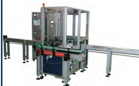
Collaudo finale completo ai teleruttori. Fino a 4 contatti di potenza e 3 ausiliari. Prove di: resistenza ohmica della bobina e dei contatti, SURGE, corrente assorbita, assestamento contatti, configurazione contatti, tensione di rilascio.
