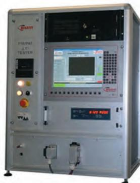
Letture automatiche fino a 5 canali con rilievo per punti della curva di riscaldamento. Altre caratteristiche come F13/PAT.
