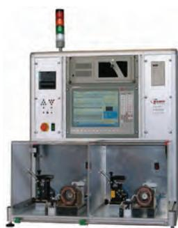
Questa versione è specializzata per collaudare statori per compressori ermetici. Oltre alle caratteristiche della H5/NCP: tensione di prova 4 Kv, prova di isolamento e 2 timbratrici per statori buoni.
