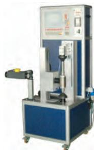
Per rotori di medie dimensioni o per pompe sommerse. Scansione automatica del trasduttore per rotori superiori a 150 mm di altezza. Rampa di accelerazione e decelerazione programmabile. Predisposizione per carico e scarico tramite manipolatore.
