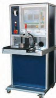
Versioni specifiche secondo le dimensioni dei pacchi statorici da provare. Possibilità di prove a 50 Hz; oltre a richiesta.
