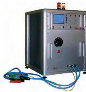
Prove di tenuta dell'isolamento all'impulso di tensione secondo la norma EN 60034-25.
