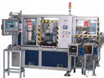
Tramite sistema a tavola rotante e robot di carico e scarico si effettuano prove di corrente erogata a diverse velocità, rilievo curve caratteristiche, timbratura, o punzonatura dati. Rilievo vibrazioni. Tempistiche: 12÷15".
