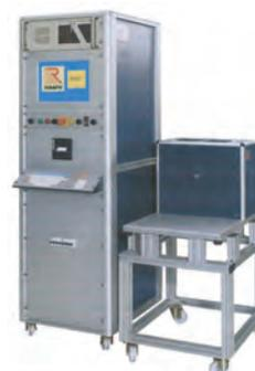
Collaudo automatico computerizzato per il rilievo caratteristiche motori:
