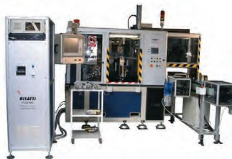
Tramite sistema a tavola rotante e robot di carico e scarico si effettuano prove di coppia/giri/corrente assorbita. Alimentatore programmabile 2.000 A. Freno tramite brushless. Vibrazioni.
