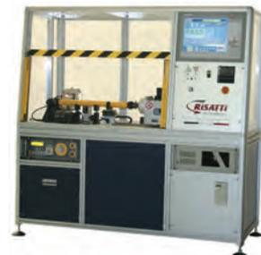
Collaudi di sicurezza, funzionali ed a carico. Tempo di ciclo completo in 35"-45". Attacchi universali. In opzione: regolazione fine corsa, controllo telecomando, timbratura. Soluzioni su tavola rotante per riduzione tempo ciclo.
