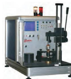
Collaudo automatico a microprocessore per piccoli e medi rotori avvolti. Prove: di resistenza, isolamento, rigidità, SURGE. Carico e scarico manuale. Tempo di ciclo: circa 0,5" per lama.
