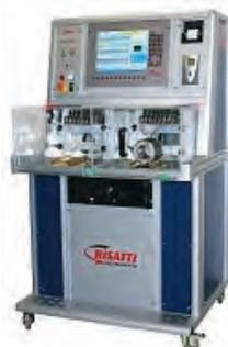
Versione espandibile come tipo di prove e fino a 32 terminali. Tensione Max 5 Kv. Rilievo scariche parziali, etichettatrice, sensori infrarosso, condizionatore, connessione a server e ad internet.
