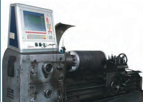
Adatto per grandi rotori pressofusi con meccanica adattata dal cliente (esempio tornio). Scansione del captatore manuale. Altre caratteristiche come il modello O6/C.
