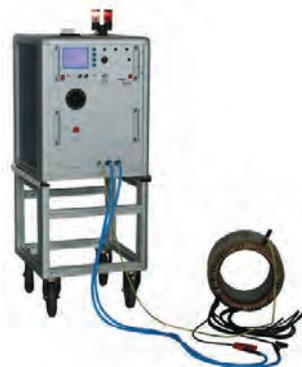
Caratteristiche e prove come H3/6 ma con SURGE e rigidità in D.C., massimo 30 KV.
