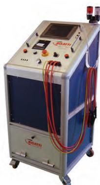
Caratteristiche e prove come H3/6 ma con SURGE e rigidità in D.C., massimo 12 KV. Esecuzione carrellata.
