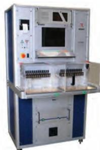
Prova di resistenza ohmica, rigidità max 5 KV, isolamento, parametri a vuoto (corrente primaria e tensioni secondarie), fase degli avvolgimenti. Standard 12 morsetti, oltre opzionali.
