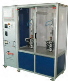
Permette di collaudare su 2 stazioni specializzate, rotorii avvolti di qualsiasi tipo. Prove di resistenza ohmica, resistenza saldatura, isolamento, rigidità, SURGE.
