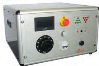
Prove di resistenza ohmica, rigidità massimo 3KV, parametri a vuoto (corrente primaria e tensioni secondarie). Massimo n.6 avvolgimenti.
