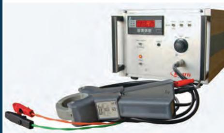
Permette di rilevare il numero di spire di una matassa o bobina e la sua resistenza ohmica. Fondoscala spire: 200 - 2.000 - 20.000. Resistenza: 2 - 20 - 200 $\Omega$ . Altri a richiesta.
