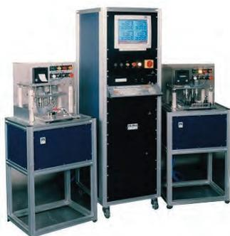
Collaudi di funzionamento, isolamento, collaudi dimensionali e presenza componenti vari. Meccanica di posizionamento e contattazione intercambiabile.
