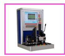
Collaudo per piccoli rotori pressofusi gestito da PC. Dimensioni massime: Ø 120 mm, H 150 mm con e senza albero. Carico e scarico manuale.
