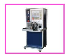
Versioni specifiche secondo le dimensioni dei pacchi statorici da provare. Possibilità di prove a 50 Hz; alte frequenze a richiesta. Visualizzazione curva isteresi.
