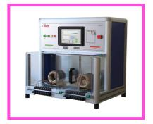
Versione standard per statori fino a 8 terminazioni, 5 prove. Tensione Max 3 KV.
